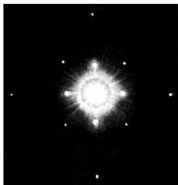
Figura 20. Figura de difração ou transformada de Fourier de uma grade quadriculada. Extraída de [1].
