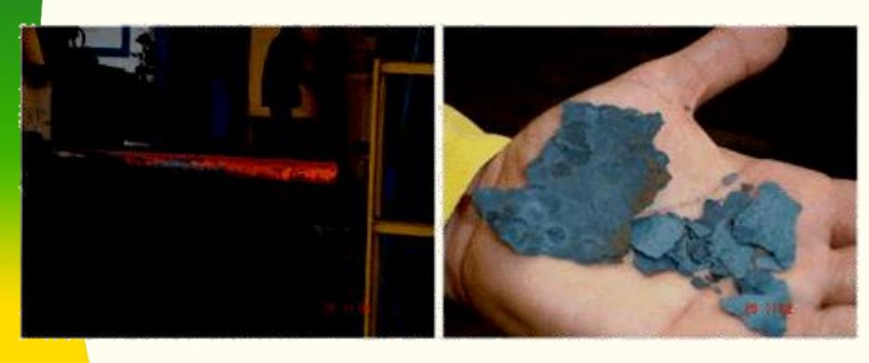
Figura 1 - Carepas na superfície do tarugo de aço (esquerda) e carepas eliminadas pelo processo (direita).
