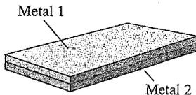
(b) A lâmina se curva quando a temperatura é elevada.
