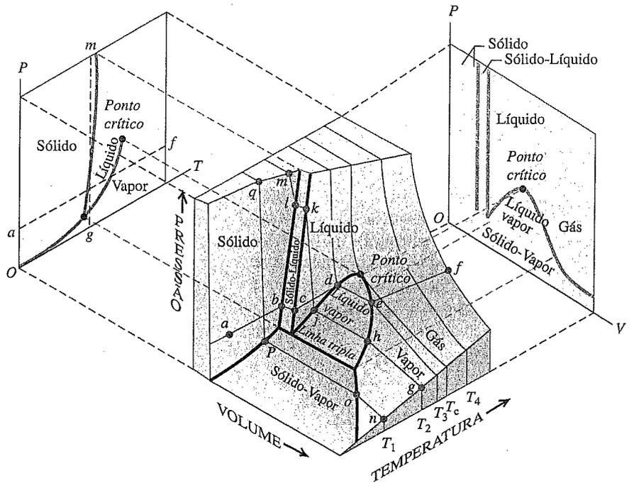
**Figura 18.27** Uma superfície PVT para um gás ideal. No lado esquerdo, cada curva corresponde a certo volume constante; no lado direito, cada curva corresponde a uma certa temperatura constante.
