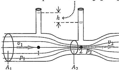
Figura 14.26 O medidor de Venturi.
