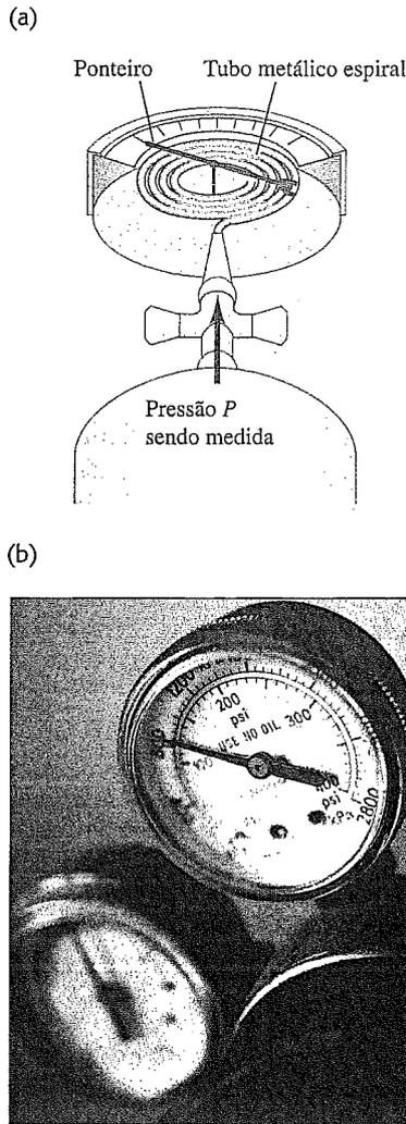
**Figura 14.10** Um manômetro Bourdon. Quando a pressão no interior do recipiente aumenta, o tubo infla ligeiramente, produzindo uma deflexão do ponteiro sobre a escala. (b) Um manômetro Bourdon usado em um tanque de gás comprimido.
