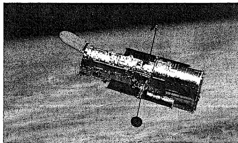
Figura 12.13 Com 13,2 m de comprimento e massa igual a 11000 kg, o Telescópio Espacial Hubble está entre os maiores satélites colocados em órbita.
