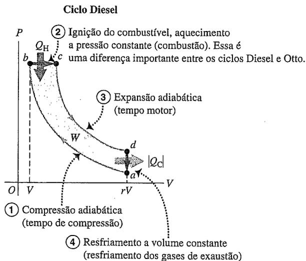
Figura 20.7 Diagrama PV de um ciclo Diesel ideal.
