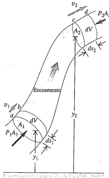
**Figura 14.23** Deduzindo a equação de Bernoulli. O trabalho total realizado sobre um elemento do fluido pela pressão do fluido circundante é igual à variação da energia cinética acrescida da variação da energia potencial gravitacional.
