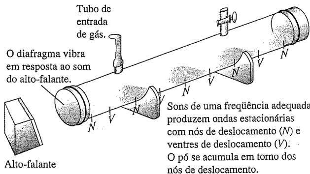
**Figura 16.12** Demonstração de ondas estacionárias por meio de um tubo de Kundt. As regiões sombreadas representam a densidade do gás no instante em que a pressão do gás nos nós de deslocamento é máxima ou mínima.
