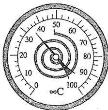
Figura 17.3 Lâmina bimetálica funcionando como termômetro.
