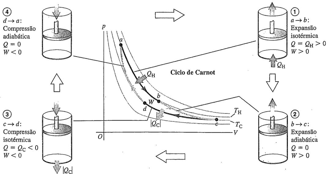
**Figura 20.13** Ciclo de Carnot para um gás ideal. No diagrama PV, as linhas finas são isothermas (curvas com temperatura constante) e as linhas grossas são curvas adiabáticas (curvas com transferência de calor igual a zero).
