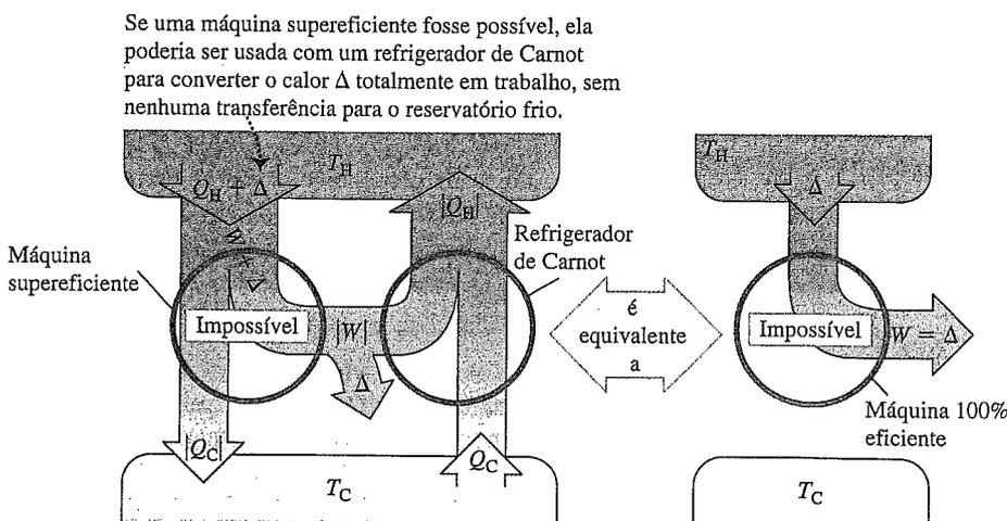
**Figura 20.15** Provando que a máquina de Carnot possui a maior eficiência possível. Uma máquina 'supereficiente' (mais eficiente do que uma máquina de Carnot) combinada a um refrigerador de Carnot poderia converter o calor totalmente em trabalho sem nenhuma transferência de calor para o reservatório frio. Isso violaria a segunda lei da termodinâmica.
