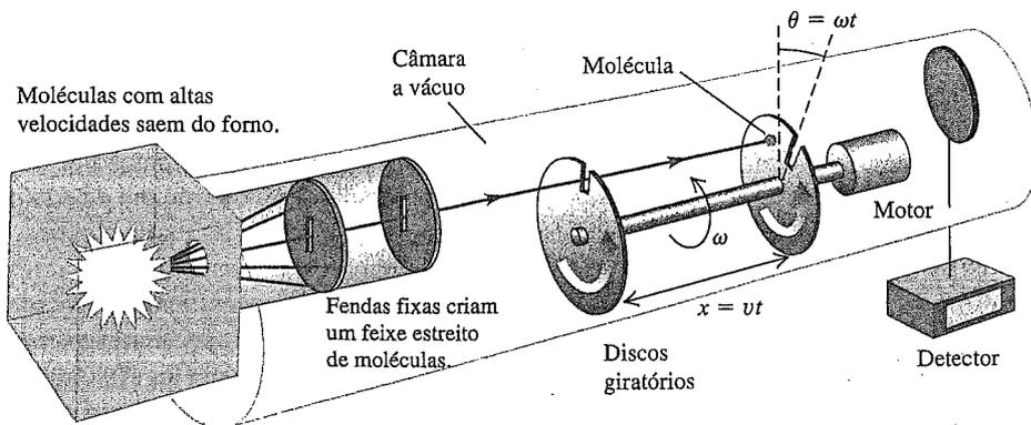
**Figura 18.22** A molécula com uma velocidade  $v$  está passando pela fenda do primeiro disco giratório. Quando ela atinge o segundo disco giratório, os discos giraram de um ângulo de seleção  $\theta$ . Se  $v = \omega x/\theta$ , a molécula passa pela fenda do segundo disco e atinge o detector.
