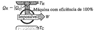
**Ciclo de Carnot:** O ciclo de Carnot opera entre dois reservatórios de calor com temperaturas  $T_H$  e  $T_C$ , e utiliza somente processos reversíveis. Sua eficiência térmica depende apenas de  $T_H$  e  $T_C$ . Um outro enunciado equivalente da segunda lei é o de que nenhuma máquina térmica operando entre os mesmos extremos de temperatura pode ter uma eficiência maior do que a máquina de Carnot. (Ver exemplos 20.2 e 20.3.)
