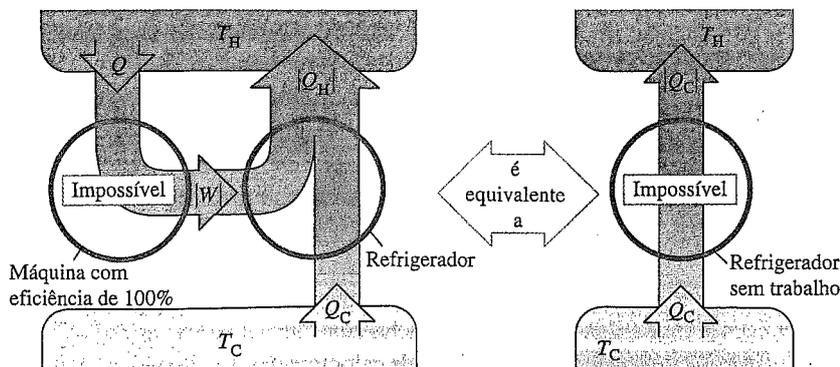
Se uma máquina com eficiência de 100% fosse possível, ela poderia ser usada juntamente com um refrigerador comum para formar um refrigerador que não precisa de trabalho, transferindo o calor  $Q_C$  de um reservatório frio para um reservatório quente sem precisar de nenhum trabalho realizado sobre o sistema.
