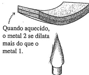
(c) Lâmina bimetálica usada em um termômetro
