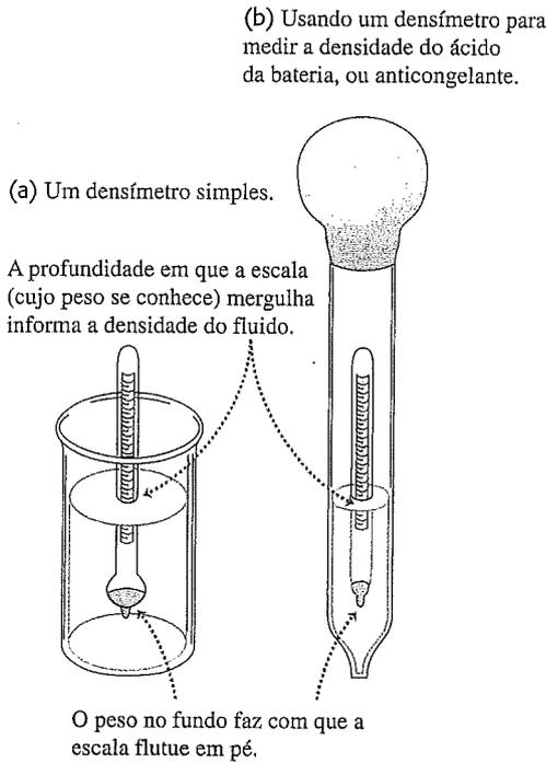
Figura 14.13 Medindo a densidade de um fluido.
