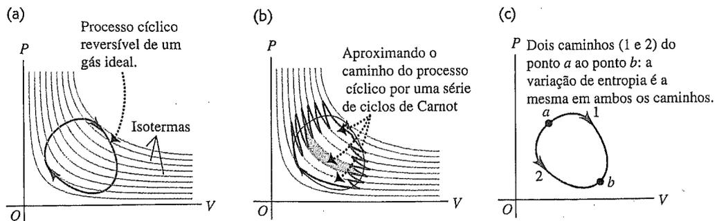
**Figura 20.20** (a) Processo cíclico reversível de um gás ideal, indicado por uma curva fechada em um diagrama PV. São mostradas várias isotermas passando pela curva. (b) O caminho em (a) pode ser aproximado por uma série de ciclos de Carnot longos e finos; um desses ciclos está sombreado na figura. A variação de entropia total é zero em cada ciclo de Carnot e no processo cíclico real. (c) A variação de entropia entre os pontos *a* e *b* independe do caminho.
