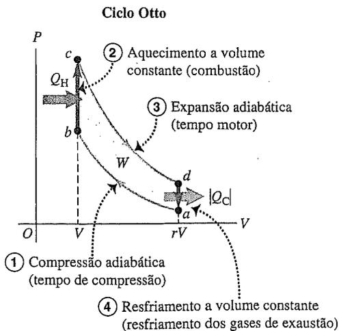
Figura 20.6 Diagrama PV de um ciclo Otto, modelo do ciclo idealizado de um motor a gasolina.
