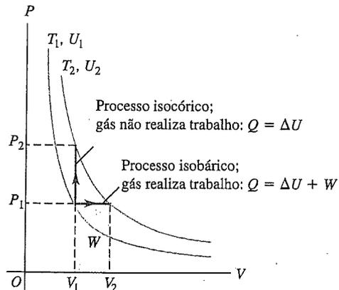
**Figura 19.19** Aumento da temperatura de um gás ideal de  $T_1$  até  $T_2$  em um processo isobárico ou em um processo isocórico. Em um gás ideal,  $U$  depende somente de  $T$ ; logo,  $\Delta U$  possui o mesmo valor em ambos os processos. Entretanto, no processo isobárico  $Q$  é maior, porque além de  $\Delta U$  devemos somar o trabalho realizado  $W$ . Logo,  $C_p > C_v$ .
