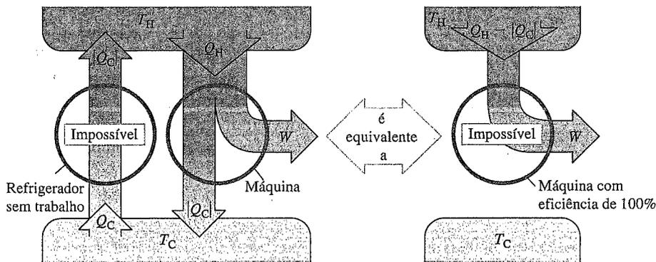
Se existisse um refrigerador que não precisasse de trabalho, ele poderia ser usado juntamente com uma máquina comum para formar um dispositivo com eficiência de 100%, convertendo o calor  $Q_H - |Q_C|$  completamente em trabalho.
