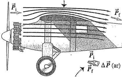
Uma explicação equivalente: a forma da asa cria um momento linear total de cima para baixo sobre o ar, então a força de reação sobre o avião é para cima.
