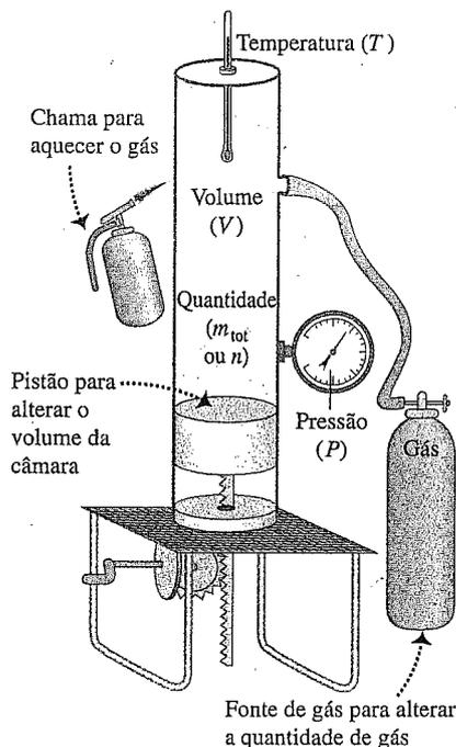
**Figura 18.1** Um dispositivo hipotético para estudar o comportamento de gases. Aquecendo o gás, variando o volume com um pistão móvel e acrescentando mais gás, podemos controlar a pressão  $P$ , o volume  $V$ , a temperatura  $T$  e o número de moles  $n$ .
