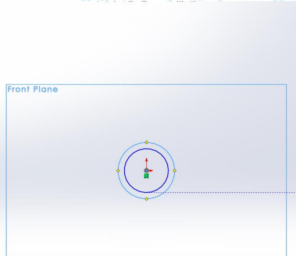
É possível determinar o valor do diâmetro das circunferências alterando o valor dos parâmetros do desenho (raio), ou clicando em **Smart Dimension** (aba **Sketch**). Clique em **Smart Dimension** e depois em uma das circunferências e coloque o valor desejado (diâmetro).
