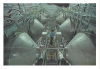
**FIGURA Q-1** Fermentações em escala industrial para a produção de biocombustível e outros produtos são realizadas em tanques que comportam milhares de litros de meio.
