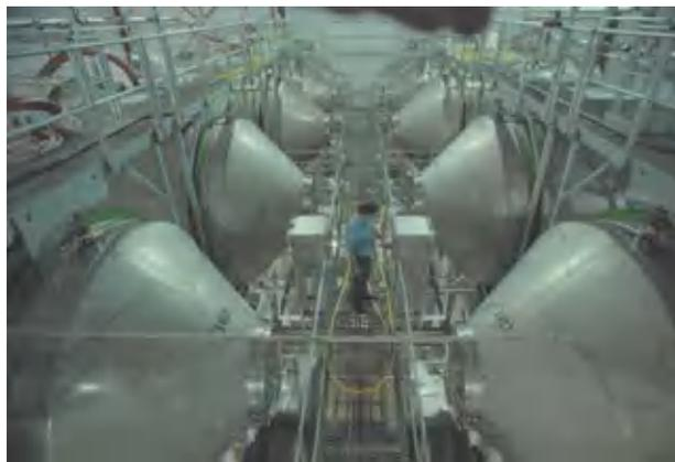
**FIGURA Q-1** Fermentações em escala industrial para a produção de biocombustível e outros produtos são realizadas em tanques que comportam milhares de litros de meio.
