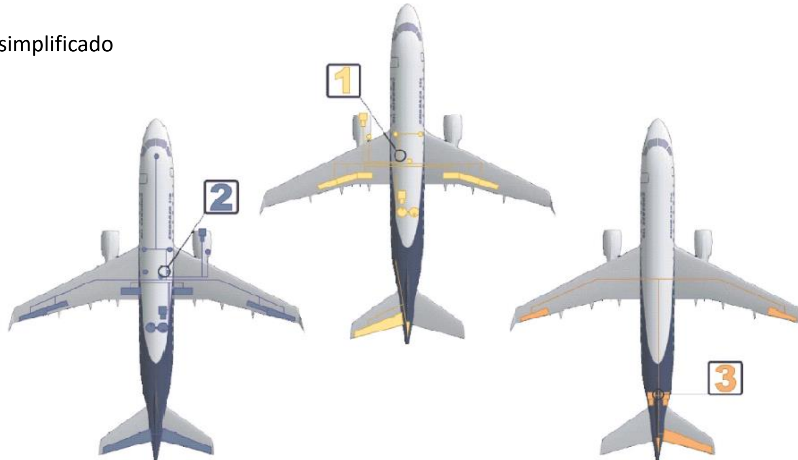
Localização dos Sistemas Hidráulicos
