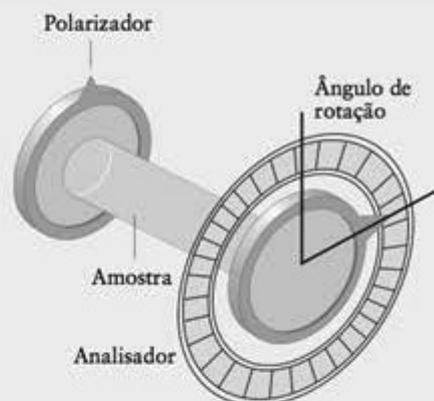
Um polarímetro determina a atividade óptica de uma substância ao medir o ângulo de rotação do plano da luz plano-polarizada provocado pela amostra.
