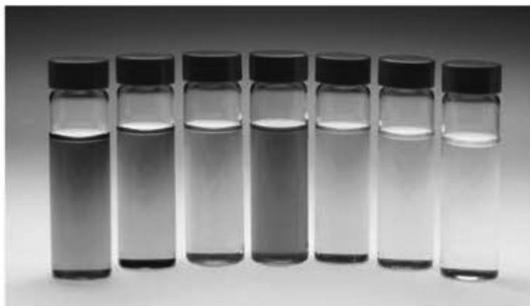
FIGURA 16.33 Efeito da mudança de ligantes com diferentes forças de campo na cor de complexos octaédricos de cobalto(III) em solução em água.
