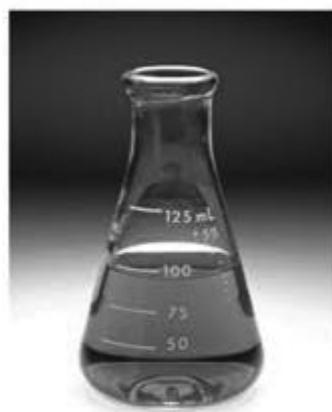
FIGURA 16.32 Como  $[\text{Ti}(\text{OH}_2)_6]^{3+}$  absorve a luz amarelo-esverdeada (de comprimentos de onda próximos a 510 nm), ele parece violeta sob a luz branca.
