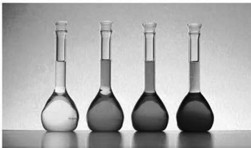
FIGURA 16.7 Muitos compostos de vanádio formam soluções com coloração viva em água. Eles também são usados nas cerâmicas esmaltadas. As cores azuis da figura são decorrentes do íon vanadila,  $\text{VO}^{2+}$ .
