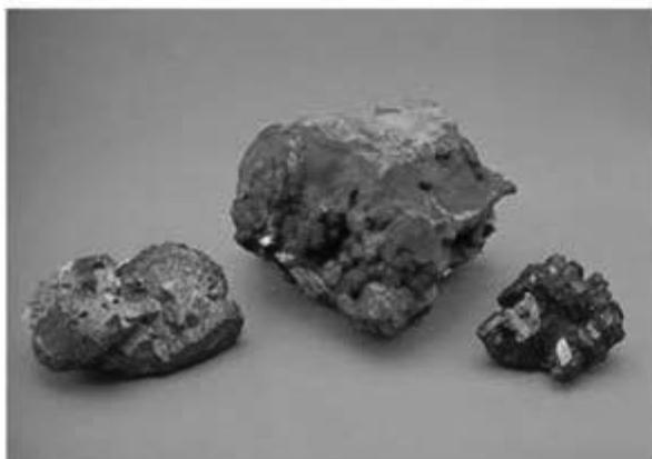
FIGURA 16.11 Três minérios de cobre importantes (da esquerda para a direita): calcopirita, CuFeS<sub>2</sub>, malaquita, CuCO<sub>3</sub>·Cu(OH)<sub>2</sub>, e calcocita, Cu<sub>2</sub>S.
