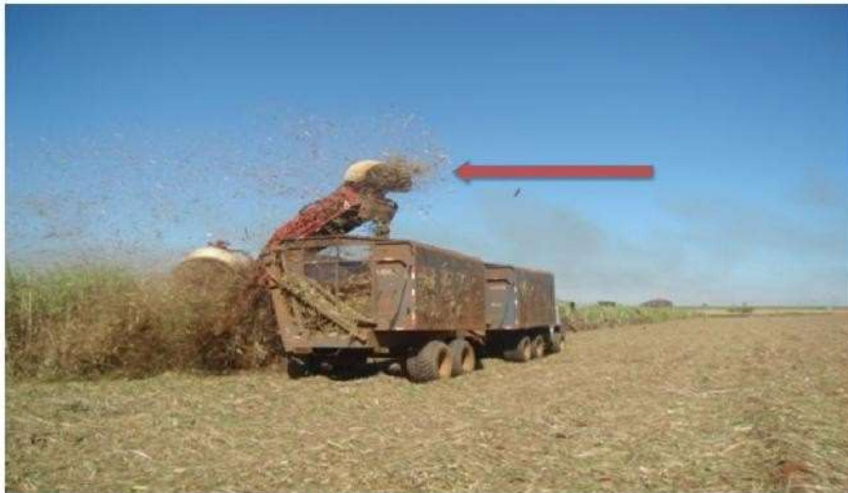
**Figura 18 Sistema do extrator de uma colhedora**
