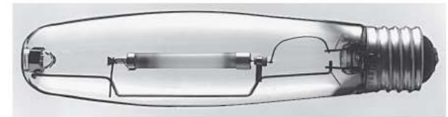
Figura 1.21 Lâmpada de vapor de sódio em alta temperatura, que se tornou possível pelo uso de um cilindro de \text{Al}_2\text{O}_3 translúcido para conter o vapor de sódio. (Observe que o cilindro de \text{Al}_2\text{O}_3 está dentro do envelope de vidro exterior.) (Cortesia da General Electric Company.)
