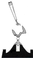
5. O anel metálico deve ser posicionado sobre a base de borracha e o restante do revestimento é vibrado lentamente para o interior do anel;
