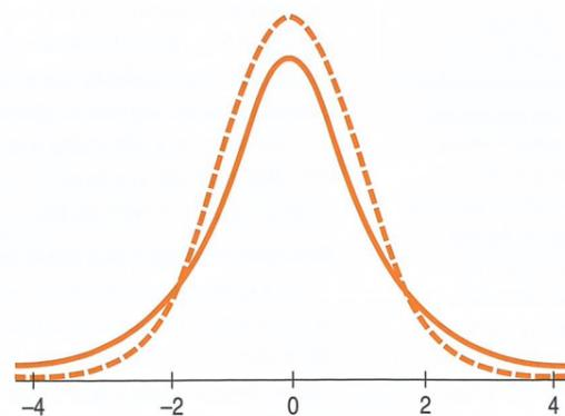
**Figura 12.1** O modelo  $t$  (curva sólida) com 2 graus de liberdade tem caudas mais grossas do que o modelo Normal Padrão (curva pontilhada). Assim, a Regra 68-95-99,7 não funciona para modelos  $t$  com pequenos graus de liberdade.
