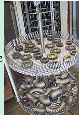
Jateamento com areia em câmara fechada
