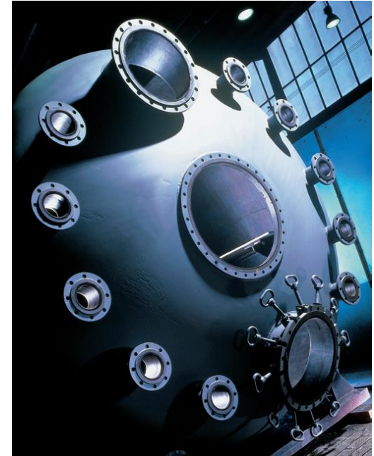
Reator protegido com camada espessa de borracha clorada.
