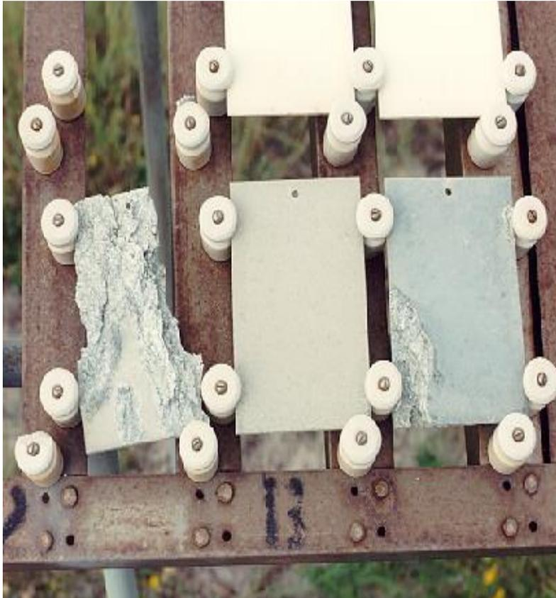
Corpos de prova de Al expostos em estação de corrosão atmosférica marinha
