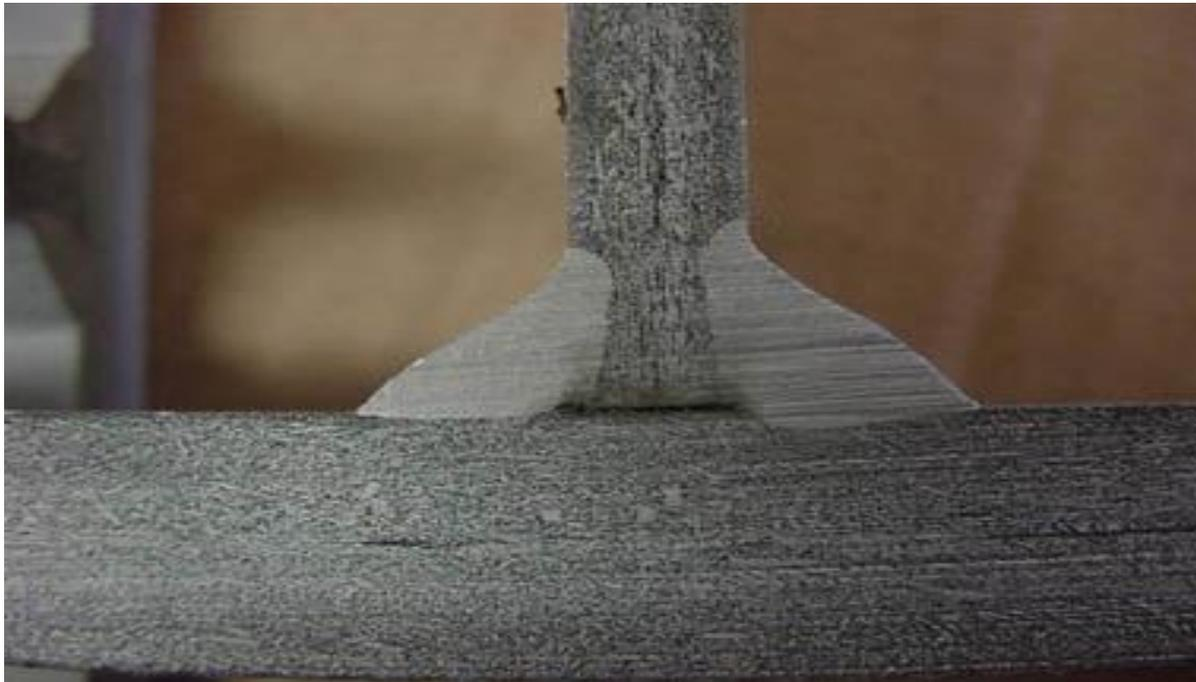
Fig. 4 – Macroestrutura de junta soldada
