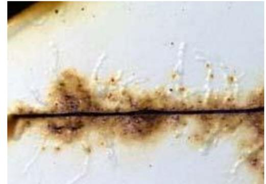
A corrosão ocorre pela diferença na concentração de O<sub>2</sub> na cabeça e na cauda do "túnel". Formam-se produtos de corrosão sob o revestimento. Isso ocorre em revestimento com fraca aderência. Em vernizes transparentes, há perda estética.
