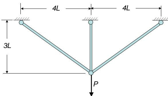
A treliça da figura é formada por barras de seção transversal igual, de área  $A$ . O material das barras é elastoplástico com tensão de escoamento  $\sigma_y$ . Pede-se o valor máximo da força  $P$  que a estrutura pode suportar.
