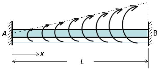
A barra prismática circular da figura tem comprimento  $L$  e está engastada nas suas duas extremidades. Ela está carregada por um torque distribuído  $t(x)$ , que varia linearmente, de zero na extremidade  $A$  até um valor  $t_0$  na extremidade  $B$ . Determine os torques reativos nas extremidades  $A$  e  $B$  da barra.
