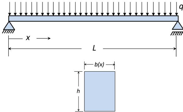
A viga da figura tem seção transversal retangular de altura  $h$  constante e largura  $b(x)$  (varia com a posição). Sabendo que a viga está submetida a uma força distribuída  $q$  uniforme, determine a largura  $b(x)$  que a seção deve ter para que a máxima tensão normal seja igual a  $\sigma_{adm}$  em todas as seções da barra (melhor aproveitamento do material). Comente o resultado que você obteve para as extremidades da viga.
