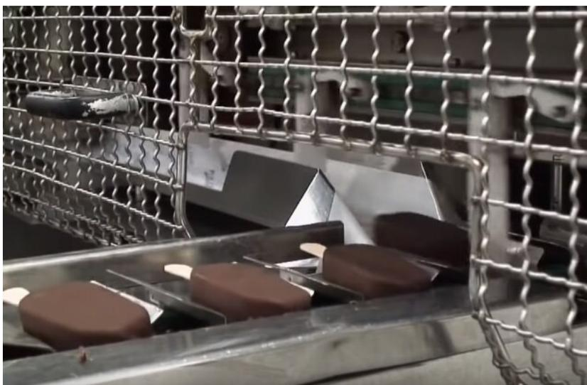
Figura 4: Máquina empacotadora de picolés
