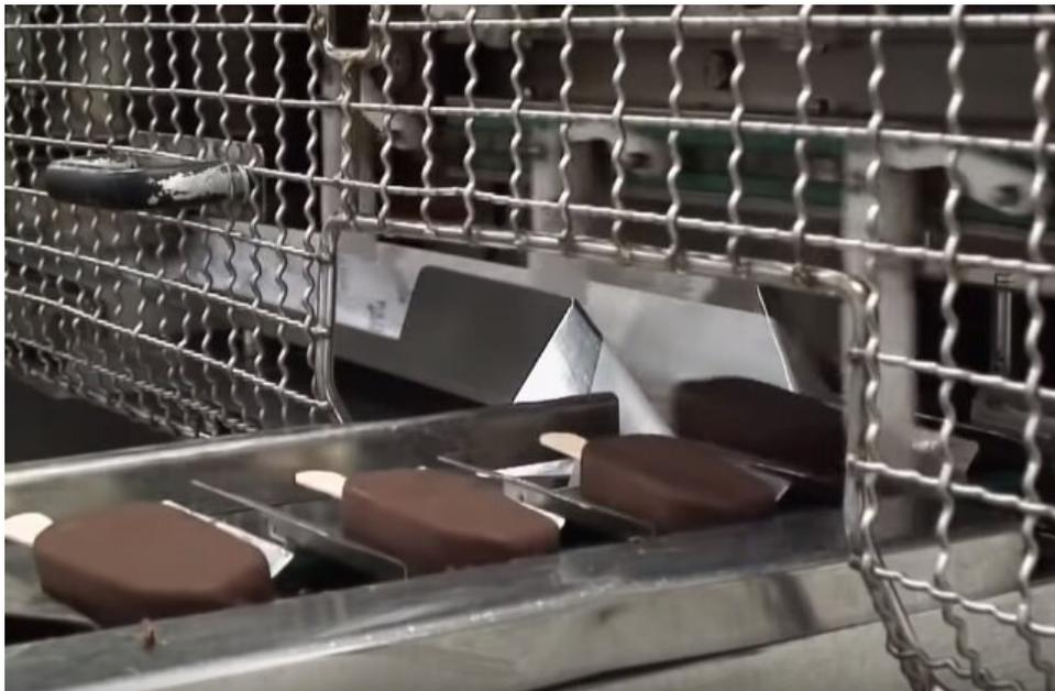
Figura 5: Máquina empacotadora de picolés
