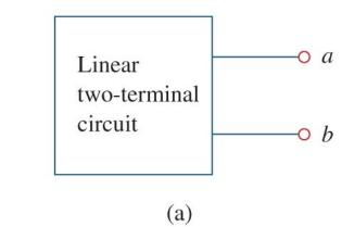
Circuito equivalente de Norton é uma transformação de fonte do circuito eq. de Thevenin!
