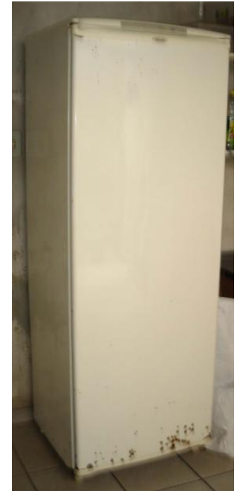
Geladeira com vários pontos de corrosão (na parte inferior da porta)
