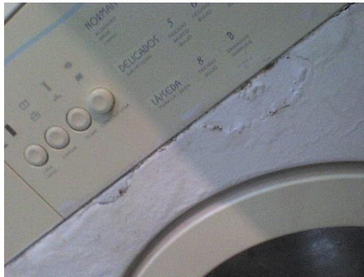
Corrosão em máquina de lavar roupas
