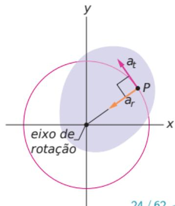
Uma barata está na borda de um carrossel em movimento. Se a velocidade angular do sistema (carrossel + barata) é constante, a barata possui (a) uma aceleração radial e (b) uma aceleração tangencial? Se  $\omega$  está diminuindo, a barata possui (c) uma aceleração radial e (d) uma aceleração tangencial?
