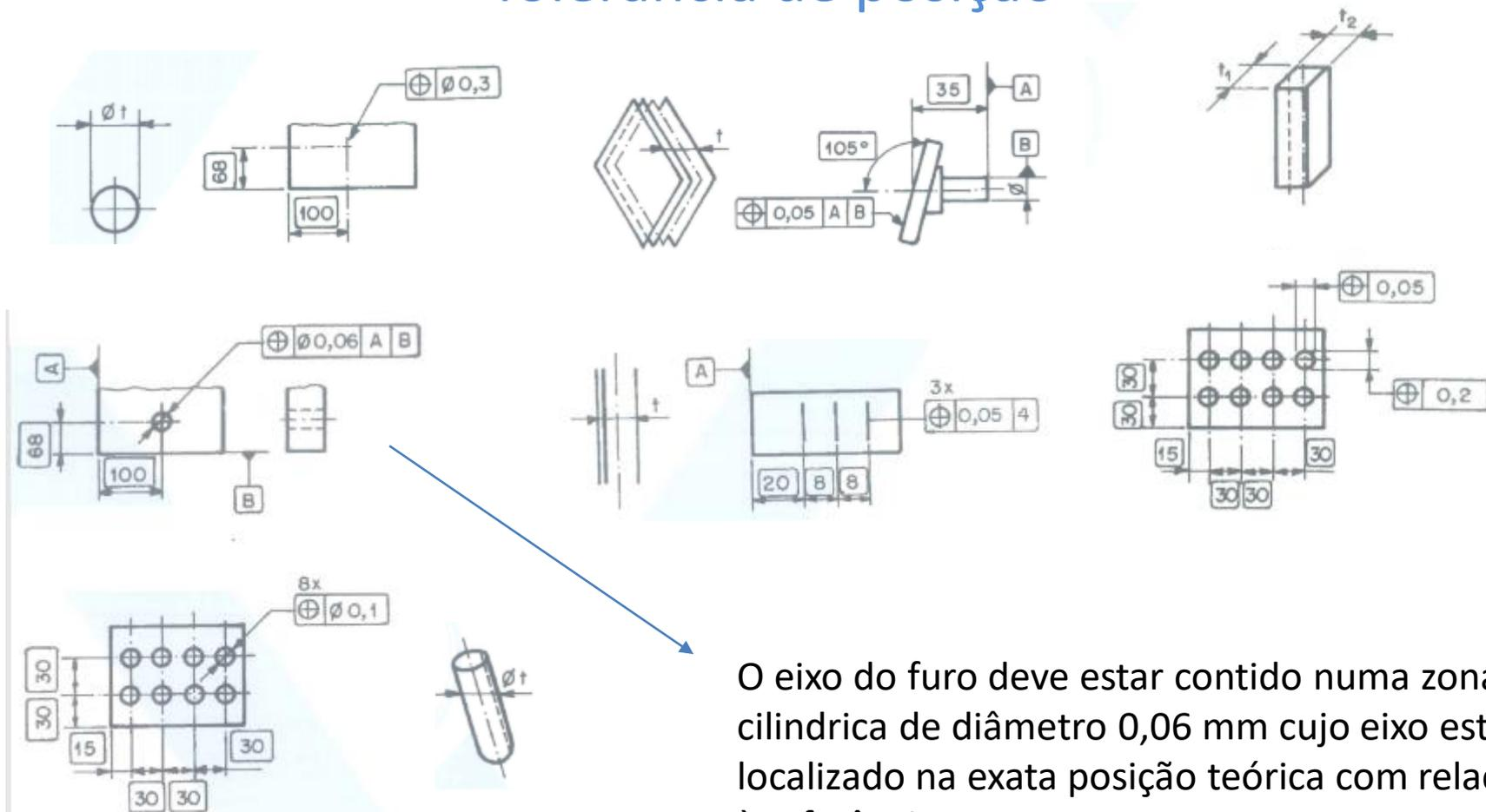
O eixo do furo deve estar contido numa zona cilíndrica de diâmetro 0,06 mm cujo eixo está localizado na exata posição teórica com relação à referência.
