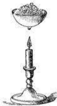
Fig. 2: Montagem utilizada para coletar uma gota da água proveniente da combustão da vela (Faraday, 2002, p. 66).
