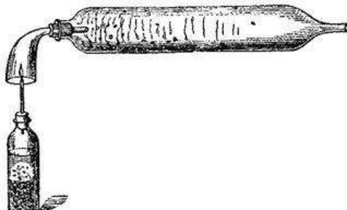
Fig. 5: Condensação da água formada pela combustão do hidrogênio dentro da "vela do filósofo" (Faraday, 2002, p. 89).
