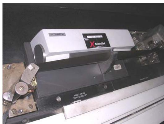
**Figura 131. Cabezal de un Ampex AVR-1 de 2".**
