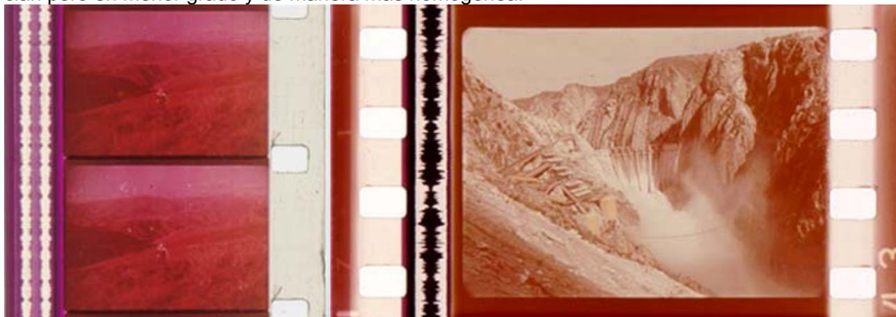
Figura 51. Degradación extrema en copia de 16mm y degradación muy avanzada en una copia 35mm
