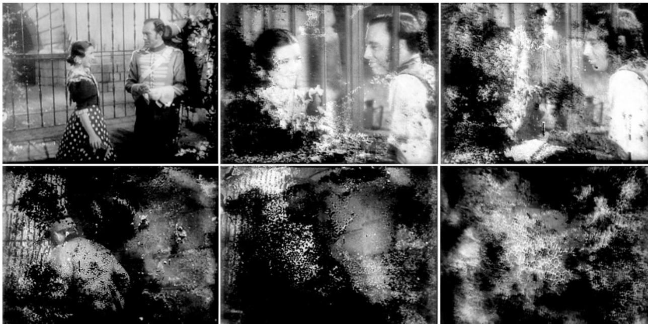
Figura 6: Avance de la descomposición, hasta la destrucción total, en los tres últimos planos de un rollo
