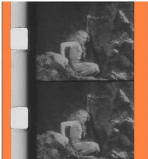
El área de imagen filmada es de 4'22 por 5'69mm (el área proyectada es de 4'01 por 5'46mm) y es casi un 30% superior a la del Standard 8. El fotograma se encuadra centrado sobre el eje de la perforación.
