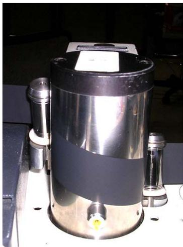
Figura 132. Registro Helicoidal. Cabezal de un Bosch BCN-51
