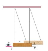
Um pêndulo balístico de massa M=5,4kg é atingido por uma bala de massa m=9,5g que fica incrustada na madeira. O CM do sistema atinge uma altura de h=6,3cm. Qual era a velocidade da bala antes da colisão?
