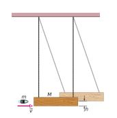
Um pêndulo balístico de massa M=5,4kg é atingido por uma bala de massa m=9,5g que fica incrustada na madeira. O CM do sistema atinge uma altura de h=6,3cm. Qual era a velocidade da bala antes da colisão?
