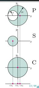
Considere uma placa de meta, fina e homogênea P, de raio 2R, da qual um disco de raio R foi removido, como mostrado na Fig. Determine o CM da placa.
