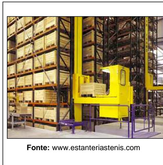
Os *porta-paletes* são estruturas de armazenamento que permitem a escolha da carga em qualquer posição da estrutura sem nenhum obstáculo para a movimentação dentro dos armazéns. Podem ser autoportantes (figura 3.10). Nesse sistema, são as próprias colunas das estruturas de armazenagem que suportam todos os esforços próprios do edifício, seja nas laterais ou na cobertura, permitindo o máximo aproveitamento do espaço vertical (em média, utiliza-se em
