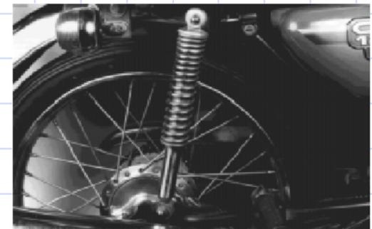
As molas amortecem choques em suspensão e pára-choques de veículos, em acoplamento de eixos e na proteção de instrumentos delicados ou
