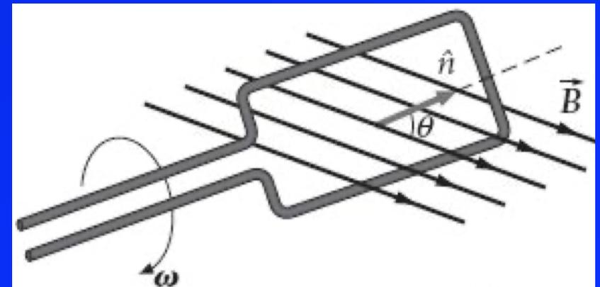
Quando a normal ao plano da bobina  $\hat{n}$  faz um ângulo  $\theta$  com um campo magnético uniforme  $\vec{B}$ , como mostra a figura, o fluxo magnético através da bobina é
