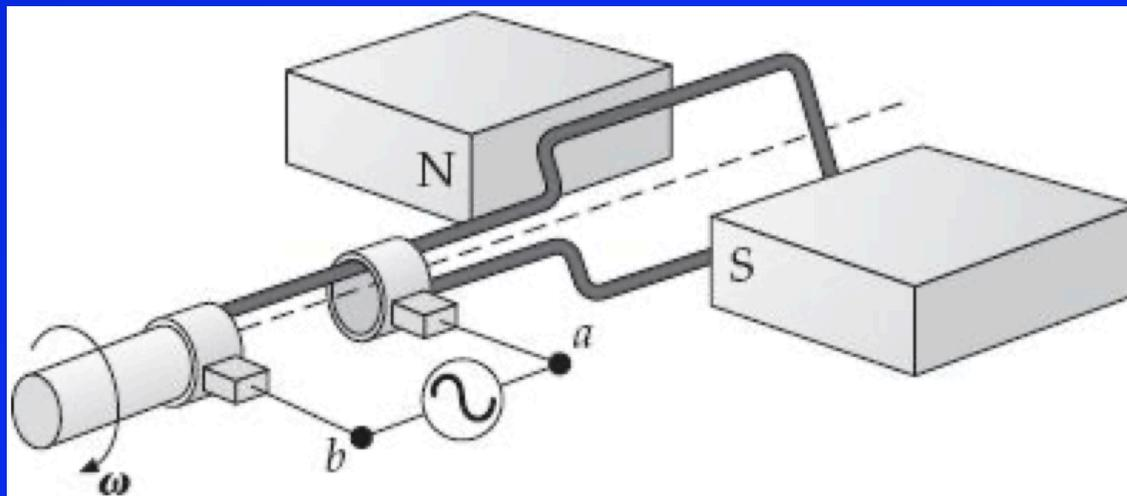
**A corrente fornecida à bobina da figura, enquanto positiva, gera um torque na bobina no sentido de alinhá-la verticalmente.**
