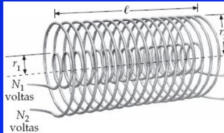
**PROBLEMA PRÁTICO 28-7** Calcule a indutância mútua  $M_{21}$  dos solenoides coaxiais da figura, determinando o fluxo através do solenoide interno devido a uma corrente  $I_2$  no solenoide externo.
