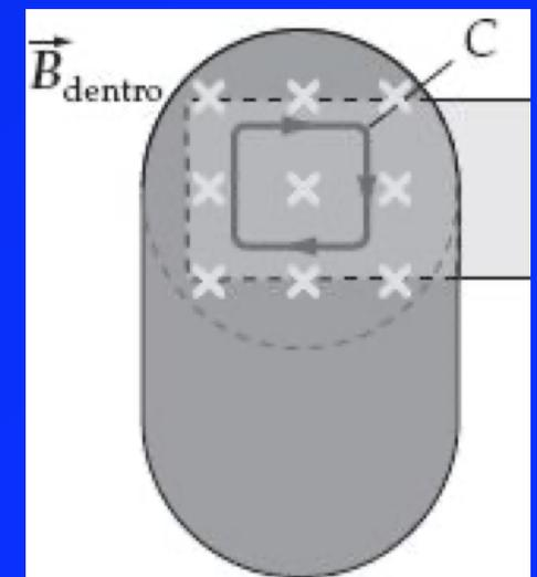
A existência de correntes parasitas pode ser demonstrada empurrando uma lâmina de cobre ou alumínio através da região entre os polos de um forte ímã permanente (veja figura). Parte da área limitada pela curva  $C$  na figura está no campo magnético e a outra parte está fora do campo magnético.
