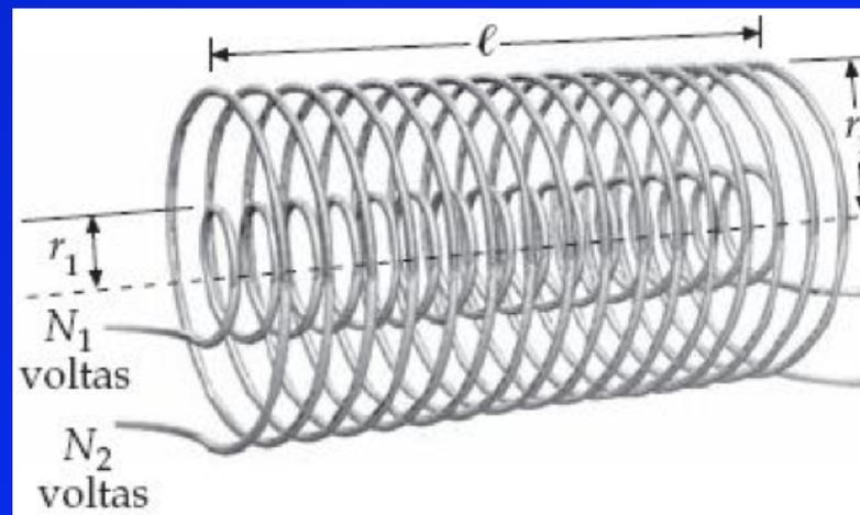
O campo magnético  $\vec{B}_1$  devido à corrente  $I_1$  no solenoide interno é uniforme e tem intensidade
