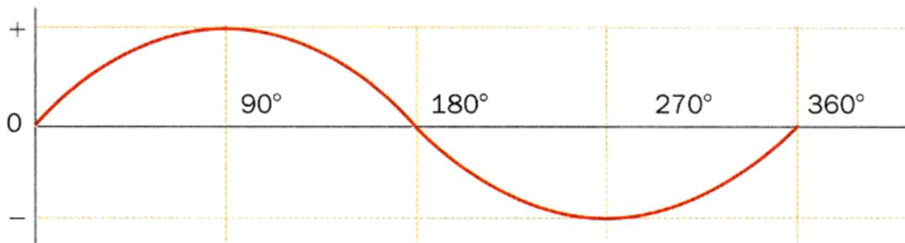
**Fig. 1-3 :** Forma de onda da tensão de saída correspondente a uma rotação completa da espira.
