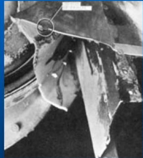
**Falha Iniciada a Partir de Furo de Rebite
