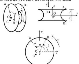
dadas, determine os ângulos  $\alpha$  e  $\beta$ , e os valores  $m_A$  e  $m_B$  das massas a serem acrescentadas na periferia da roda para fazer o balanceamento, ou seja, para que todos os esforços <u>dinâmicos</u> nos mancais sejam nulos quando a roda estiver girando com rotação  $\vec{\omega}$  constante em torno de Oz, em função dos dados.
