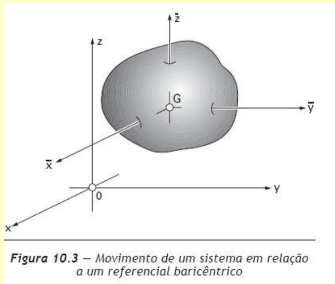
Figura 10.3 – Movimento de um sistema em relação a um referencial baricêntrico
