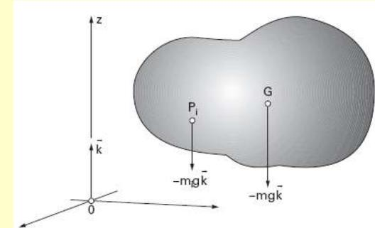
Figura 10.2 – Forças-peso de um sistema material
