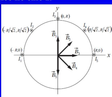
(40) Cinco fios longos, retilíneos e condutores são paralelos ao eixo z, e cada um conduz corrente I na direção +z. Determine o campo magnético no eixo z.
