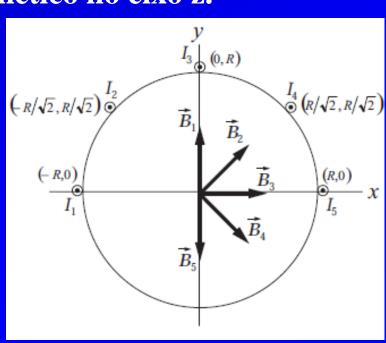
(40) Cinco fios longos, retilíneos e condutores são paralelos ao eixo z, e cada um conduz corrente I na direção +z. Cada um dos fios está a uma distância R do eixo z. Dois dos fios interceptam o eixo x, um em x = R e o outro em x = -R. Outro fio intercepta o eixo y em y = R. Um dos fios restantes intercepta o plano z = 0 no ponto  $(R/\sqrt{2}, R/\sqrt{2})$  e o último fio restante intercepta o plano z = 0 no ponto  $(-R/\sqrt{2}, R/\sqrt{2})$ . Determine o campo magnético no eixo z.
