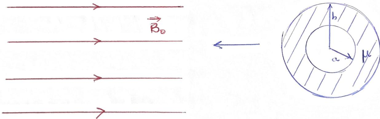
As linhas de campo magnético são uniformes antes da introdução da casca cilíndrica e devem ser deformadas pelo processo de magnetização da casca.
