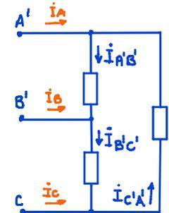
$$\begin{aligned} W_2 + W_1 &= \text{Re}\{\dot{V}_{A'C'} \dot{I}_A^*\} + \text{Re}\{\dot{V}_{B'C'} \dot{I}_B^*\} = \\ &= \text{Re}\{\dot{V}_{A'C'} (\dot{I}_{A'B'} - \dot{I}_{C'A'}) + \dot{V}_{B'C'} (\dot{I}_{B'C'} - \dot{I}_{A'B'})\} = \\ &= \text{Re}\{-\dot{V}_{A'C'} \dot{I}_{C'A'} + \dot{V}_{B'C'} \dot{I}_{B'C'} + (\dot{V}_{A'C'} - \dot{V}_{B'C'}) \dot{I}_{A'B'}\}. \end{aligned}$$
