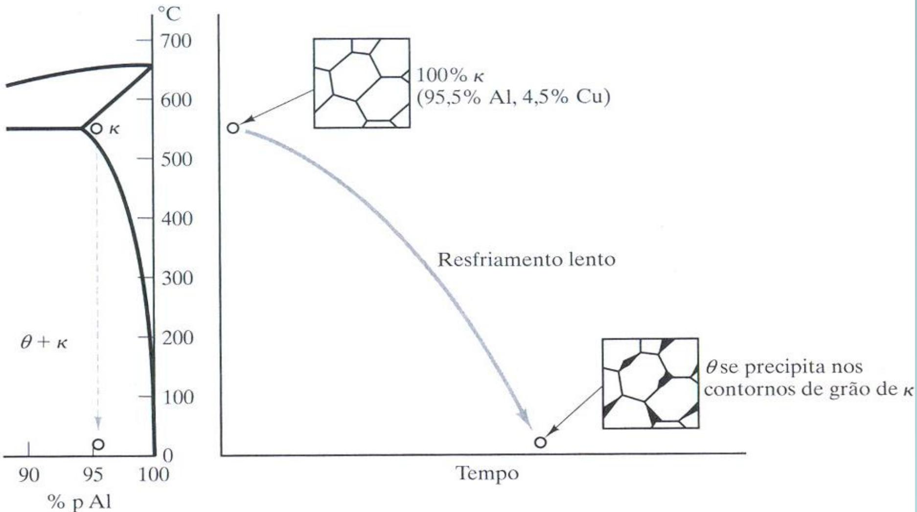
Precipitados grosseiros se formam em contornos de grão em uma liga Al–Cu (4,5% p) quando resfriados lentamente da região monofásica ( $\kappa$ ) do diagrama de fases para a região de duas fases ( $\theta + \kappa$ ). Esses precipitados isolados afetam muito pouco a dureza da liga.
