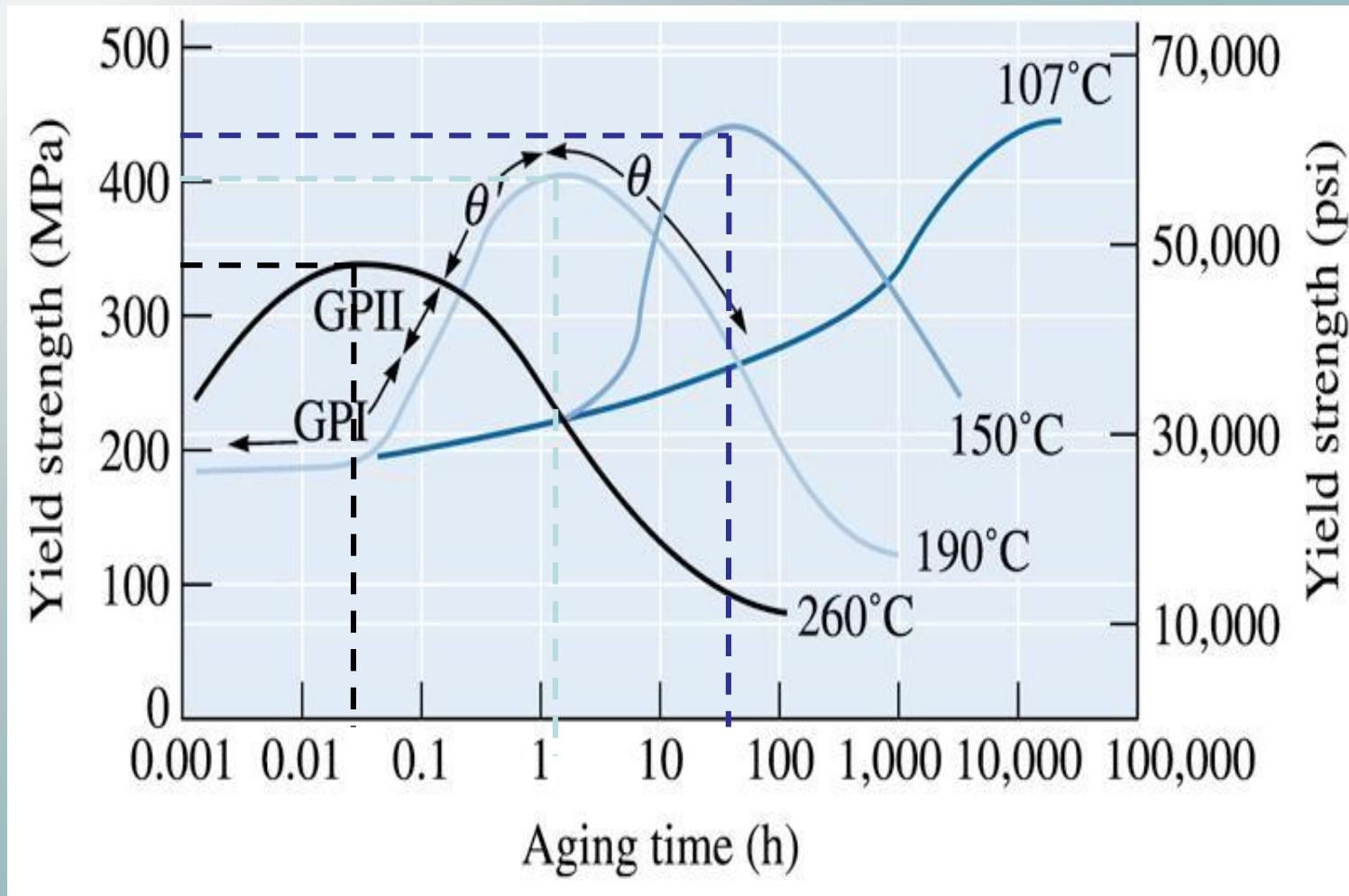
Quanto maior a Temperatura de envelhecimento menor a resistência mecânica (dureza) e menor o tempo para atingir tal dureza.
