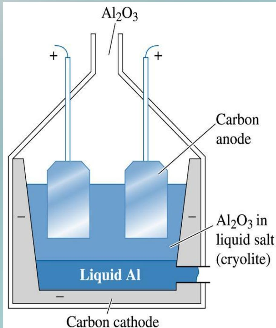
Na produção do alumínio, a redução é o processo que separa o metal do oxigênio, que formam a alumina ( $\text{Al}_2\text{O}_3$ ).
