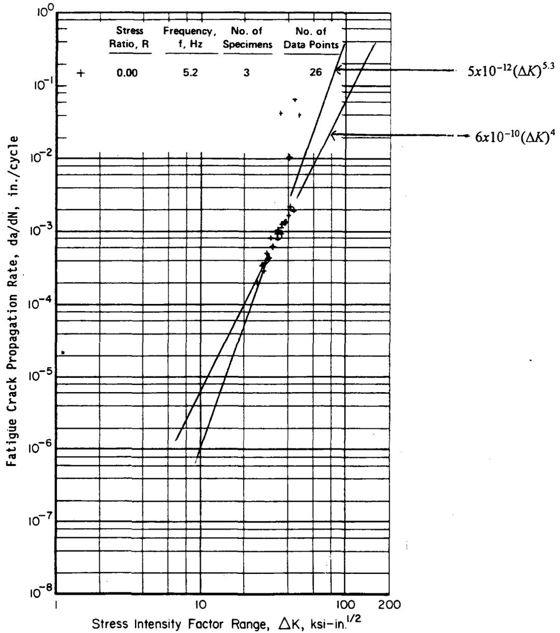
2014-T6 Al, 1.00 IN. ROLLED BAR, CC SPECIMENS, L-T DIRECTION
