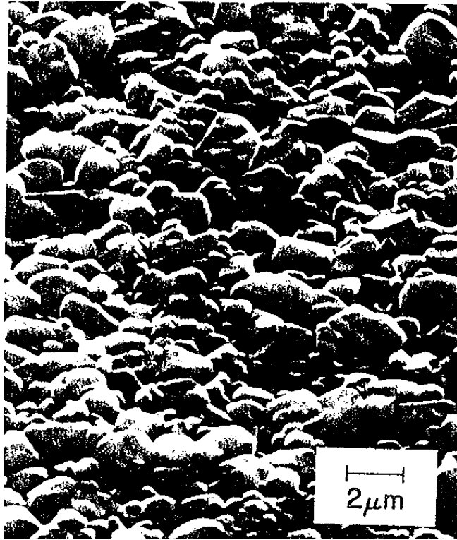
Figura 13 – Superfície da Al 2 O 3 99%, sinterizada apresentando grãos finos.
