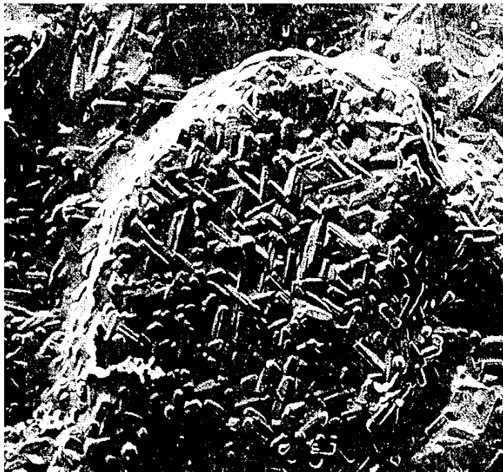
Figura 3 – Cristais de mulita na matriz de sílica formados pelo aquecimento da caulinita.
