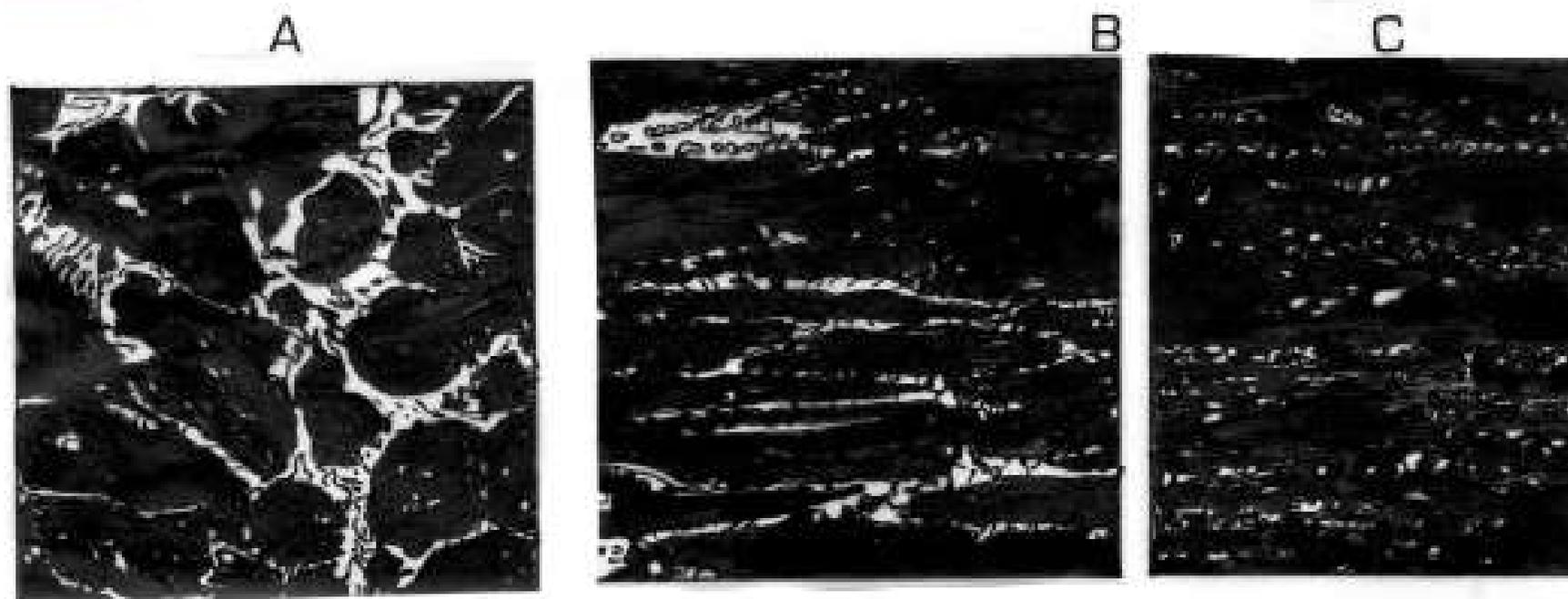
Fig. 8.26 - Microestruturas de aço M2. a) bruto de solidificação. b) forjado a quente com 75% de redução. c) forjado a quente com 90% de redução.
