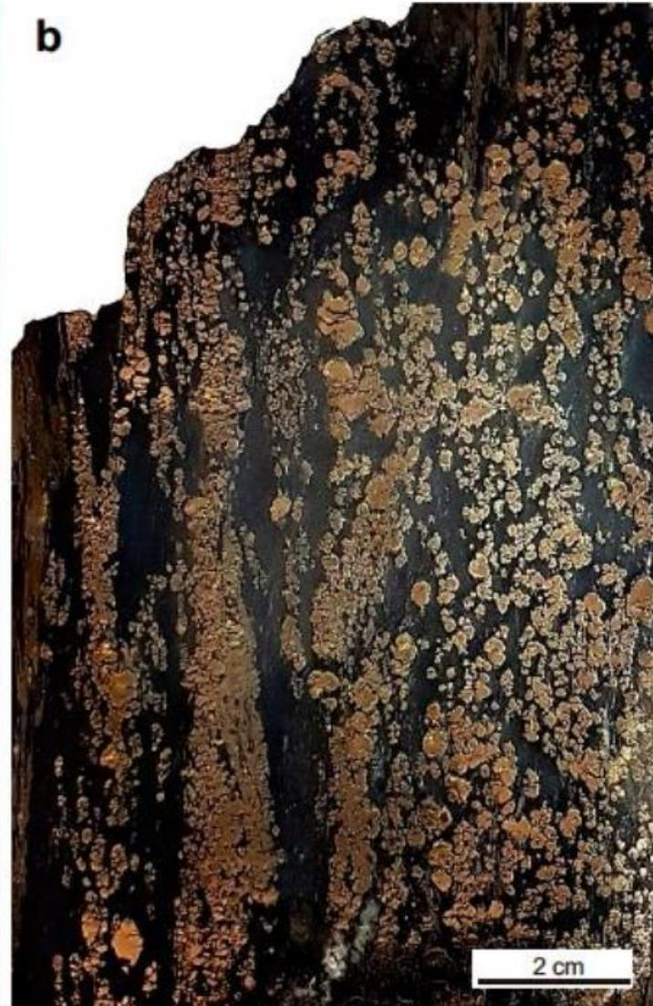
Sulfetos maciços gerados pela substituição de: (a) rochas vulcanoclásticas substituídas por polimetálicas sulfetos, de Aguas Teñidas, mostrando rochas vulcânicas dacíticas incrustadas e substituídas por sulfetos (galena, esfalerita, pirita e calcopirita) e carbonatos; e (b) folhelhos pretos de Cueva de la Mora, na qual agregados de pirita substituem amplamente o rocha.
