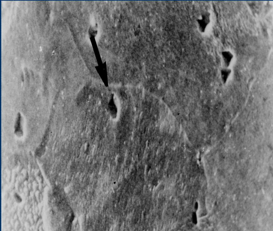
Fig. 12 – Aspecto superficial do aço AISI 409, com nióbio e titânio, após laminação convencional MEV 1000X
