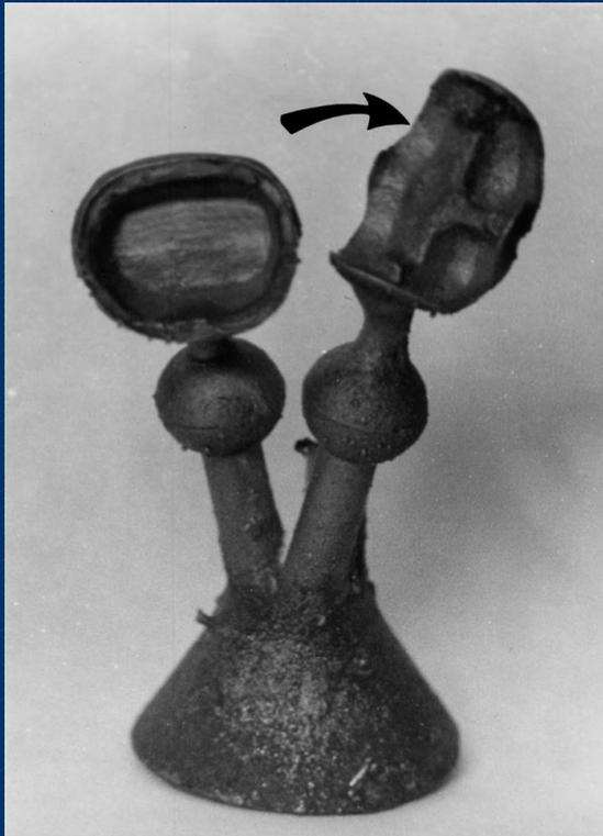
Fig. 11 - Fundição por cera perdida de uma coroa total oca e uma incrustação. Escala 3:1
