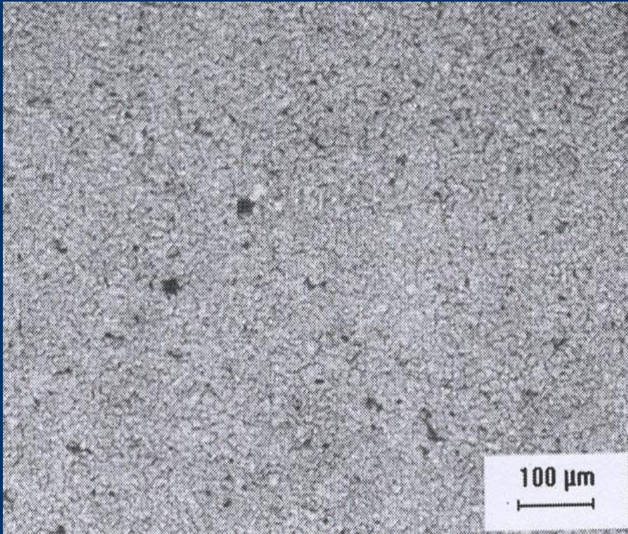
Fig. 13 – Microscopia ótica obtida a 1150° C, matriz austenítica, com tamanho de grão ASTM 10
