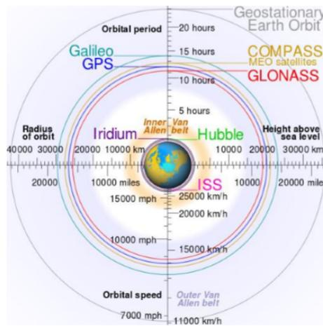
Figura 25 – Comparação entre órbitas de satélites dos sistemas globais de navegação via satélite
