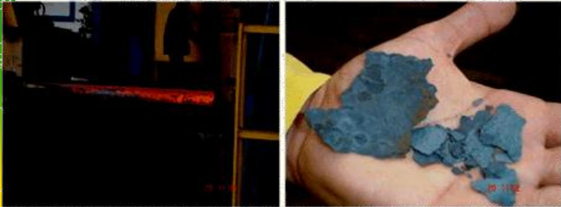
Figura 1 - Carepas na superfície do tarugo de aço (esquerda) e carepas eliminadas pelo processo (direita).
