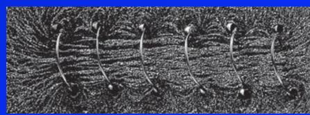
A figura acima apresenta limalha de ferro alinhada com o campo de um solenoide onde passa corrente.
