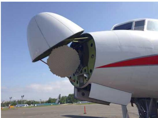
(a) Radar Meteorológico no Radome de um Avião
