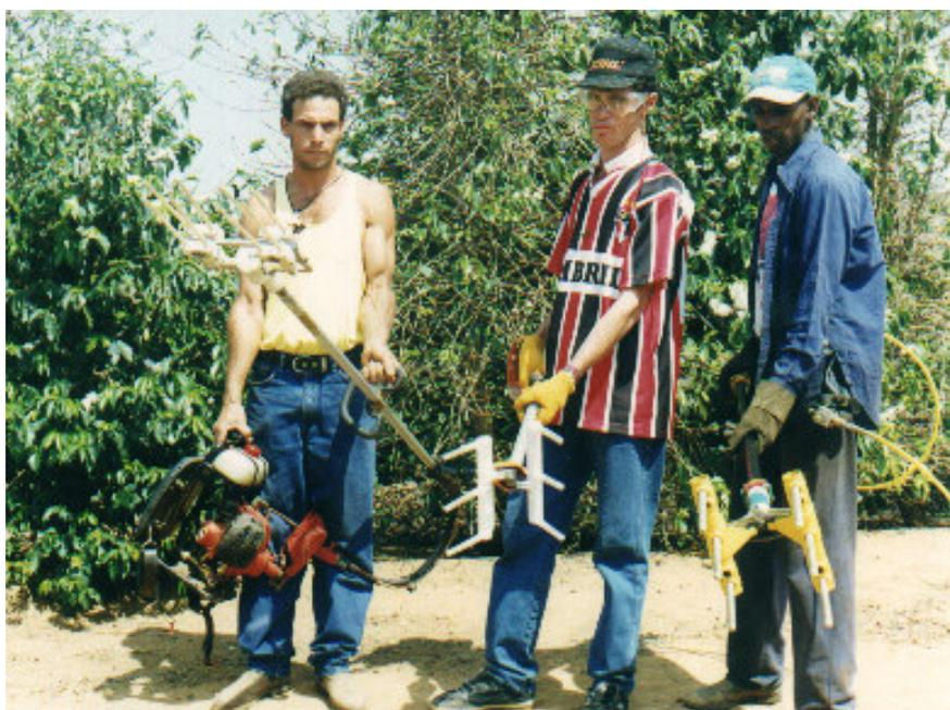
FIGURA 1 – Modelos de derrçadoras portáteis
