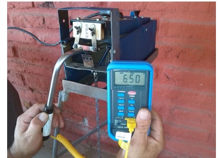
Pirômetro indicando correta temperatura da lâmina de 650°C.
