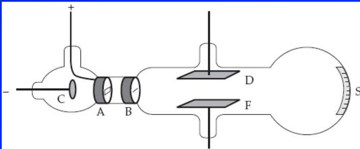
Considerando apenas a presença do campo elétrico  $\vec{E}$ , o feixe sofre uma deflexão  $\Delta y$ , que consiste em duas partes: a deflexão  $\Delta y_1$ , que ocorre quando os elétrons estão na região de  $\vec{E}$ , e a deflexão  $\Delta y_2$ , que ocorre quando os elétrons saem da região de  $\vec{E}$ .
