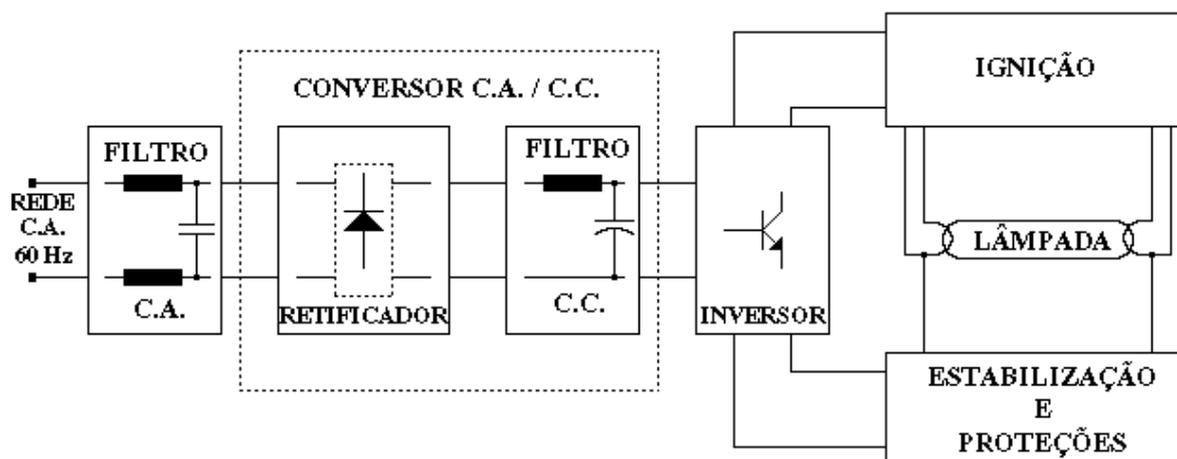
**Fig. 5** - Diagrama de blocos de um reator eletrônico
