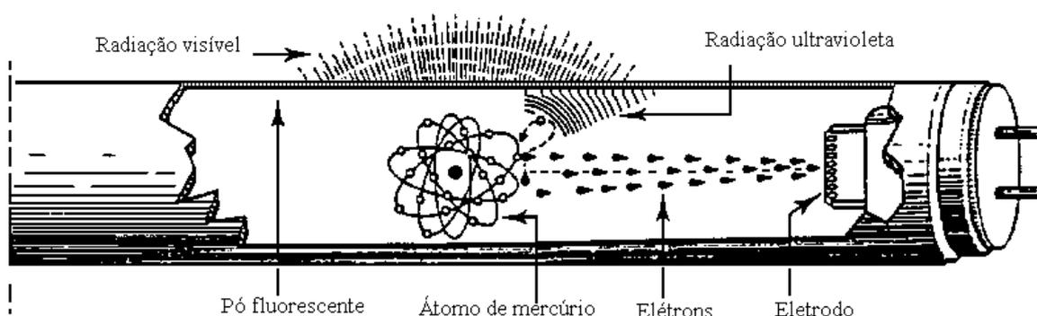
**Fig. 1** - Estrutura interna e princípio de funcionamento de uma lâmpada fluorescente
