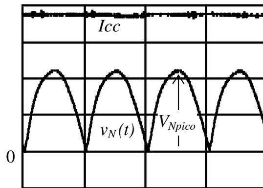
**Fig. 9** - Corrente  $I_{cc}$  no indutor  $L_f$  e tensão  $V_N$  no tap central de  $Tr$
