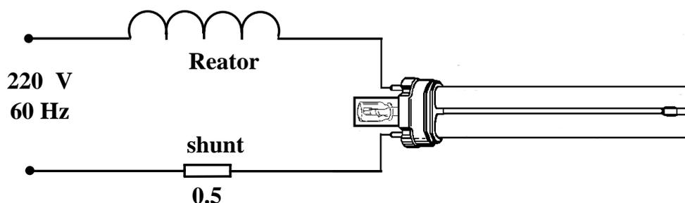
**Fig. 10** - Lâmpada fluorescente compacta com reator indutivo
