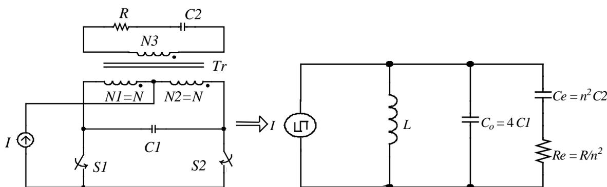
**Fig. 8** - Circuito equivalente simplificado do inversor
