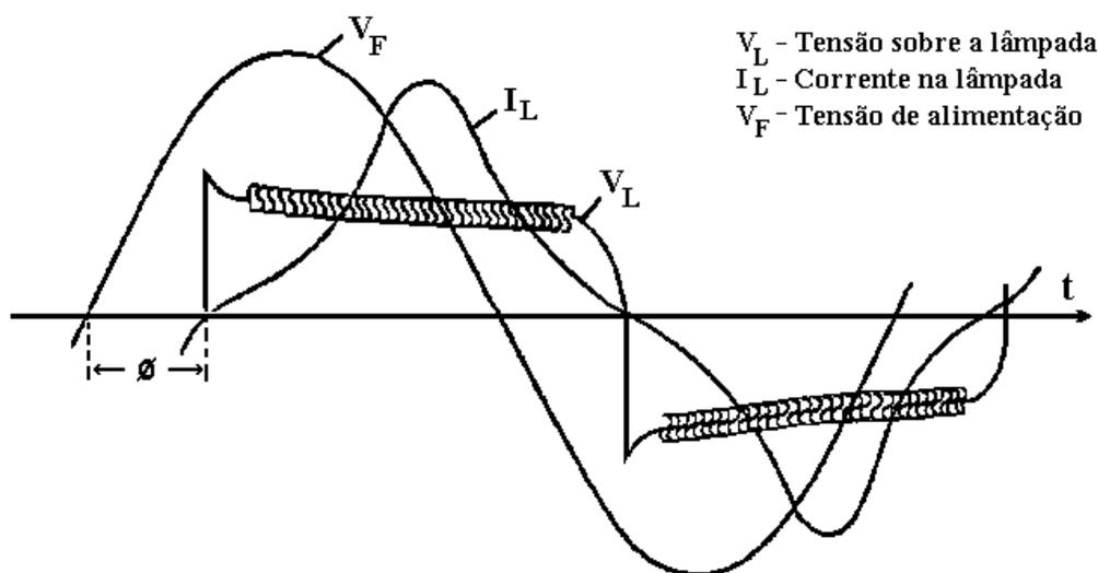
**Fig. 4** - Formas de onda para reatores indutivos
