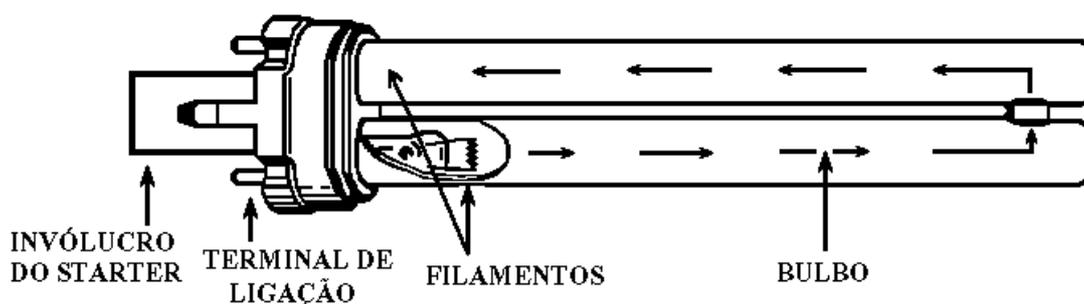
**Fig. 2** - Lâmpada fluorescente compacta com "starter" incorporado
