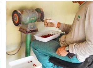
escarificação em esmeril
